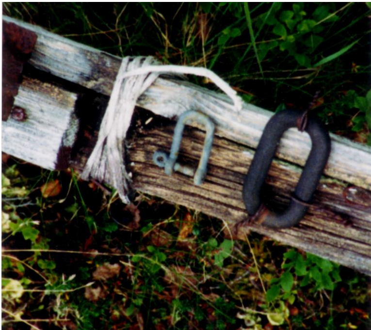
Fra venstre, taurester, sjakkell og en ring av isolerende materiale. Ringen kan ha vært benyttet til antenneanlegget. Foto: Per Ole Myhre 1994.
