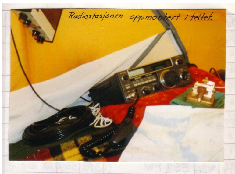
Radiostasjonen oppmontert i teltet 1990. Her kan sees antennetuner fra MFJ, Koaksialkabel, transceiveren Yaesu FT 77S med 10 Watt utgangseffekt, mikrofon og telegrafnøkkel.
